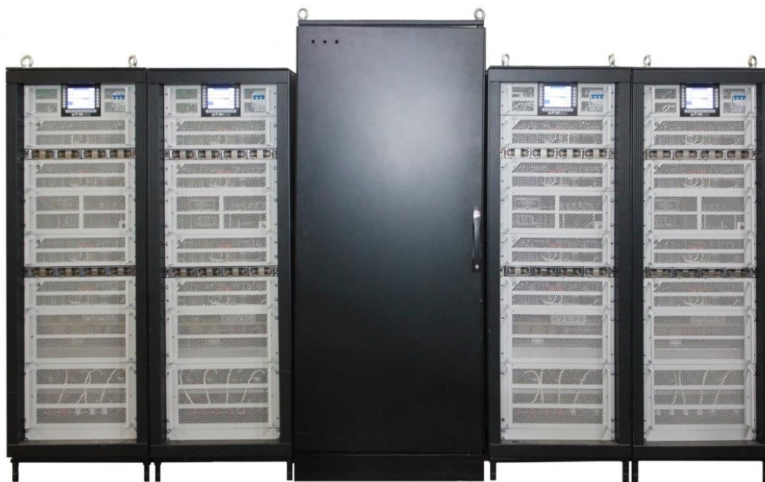
Рис. 3. Внешний вид макета передающего модуля КВ диапазона мощностью 20 кВт
