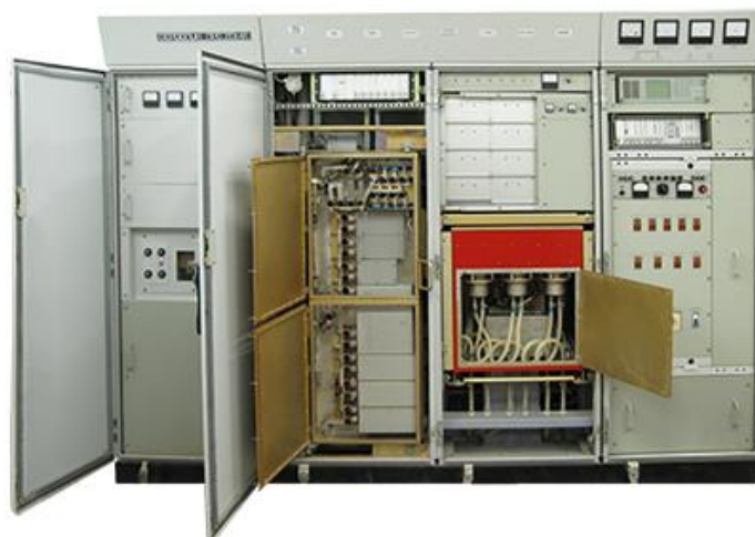
Рис. 1. Передатчик «ВОДОПАД 20». Во втором слева шкафу на переднем плане блок АнСУ с согласующими длинными линиями, в третьем слева шкафу блок усиления мощности с радиолампами с жидкостным охлаждением
